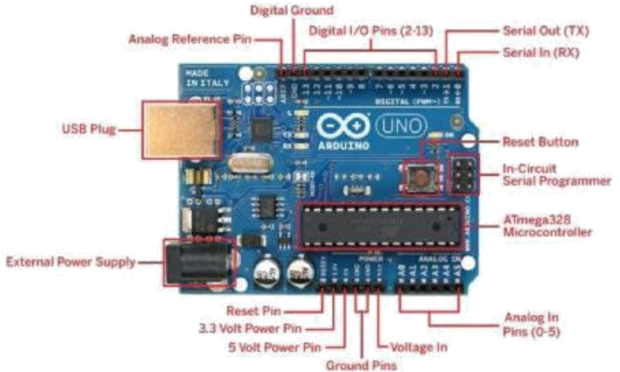
Fig. 3.2 Arduino Uno pin configuration
