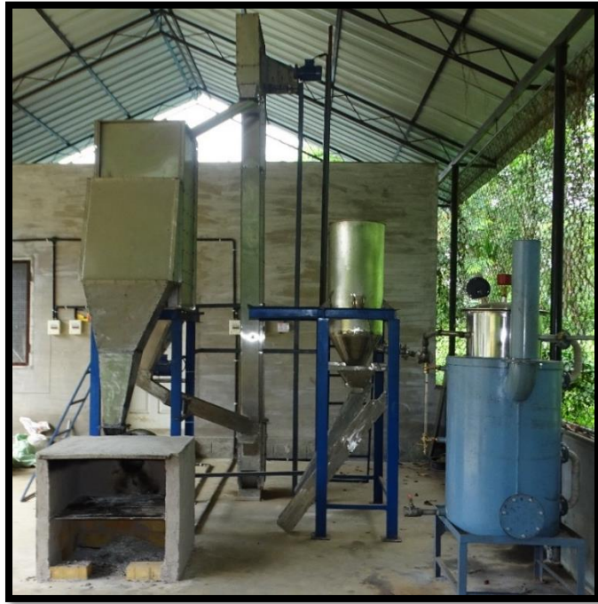
Plate 3.1 Parboiling cum drying unit
