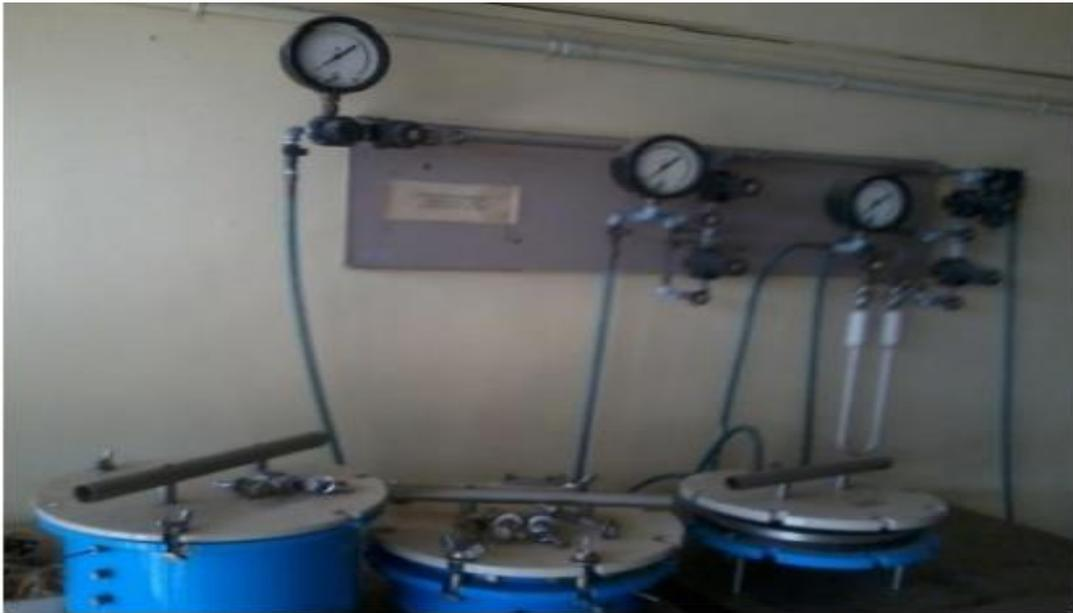
**Plate 3.9 Pressure plate apparatus**
