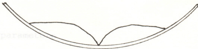
FIG 7 (d) SOIL CAKE AFTER TEST
